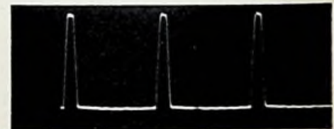
Bild 4. Impulse von der Austastwicklung des Zeilen-Transformators zum Anstoßen des Schwingkreises L 2/C 3 in Bild 3
